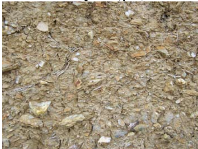
mortier de bauge : terre, fibre, cailloux
